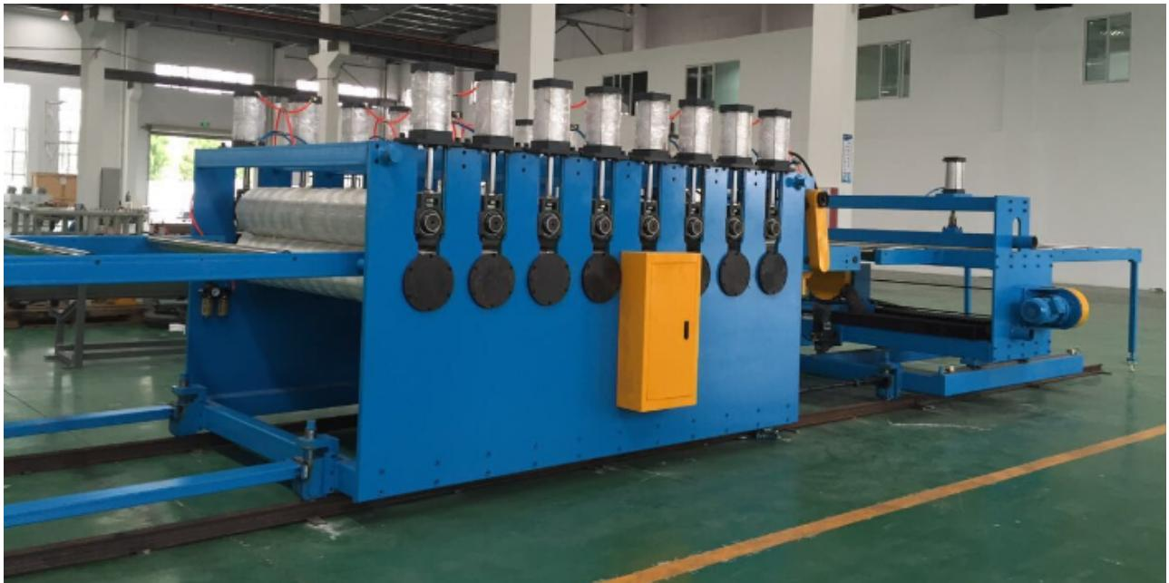
PVC发泡板生产线机器设备 PVC发泡板又称为雪弗板和安迪板，其化学成分是聚氯乙烯，所以也称为泡沫聚氯乙烯板。广泛应用于客车、火车车厢顶棚、箱体芯层、内部装潢用板、建筑物外墙板、内装饰用板、办公室、住宅、公共场所建筑物隔间，商用装饰架、无尘室用板、吊顶板、网板印刷、电脑刻字、广告标示、展板、标志用板相册板等行业及化工防腐工程、热成型件、冷库用板、特殊保冷工程、环保用板模、运动器材、养殖用材、海滨防潮设施、耐水材料、美工材料及各种轻便隔板代替玻璃天棚等。特点1. 防水，阻燃，防潮，防腐的，防蛀，重量轻，保持温度，隔音，隔热，防震等;2. 色向不改变时间长，耐辐射防老化老;3. 此产物可通过普通的木材加工工具进行制造。它可钻，锯，可钉和挖掘。4. 它可以被焊接，因为每个焊接一般规定，也可粘到其他PVC材料。5. 它具有光滑的表面，并易于进行印刷□PBM可塑生物质天合成塑料板材机器。浙江销售PVC发泡板生产线设备机器近期价格
